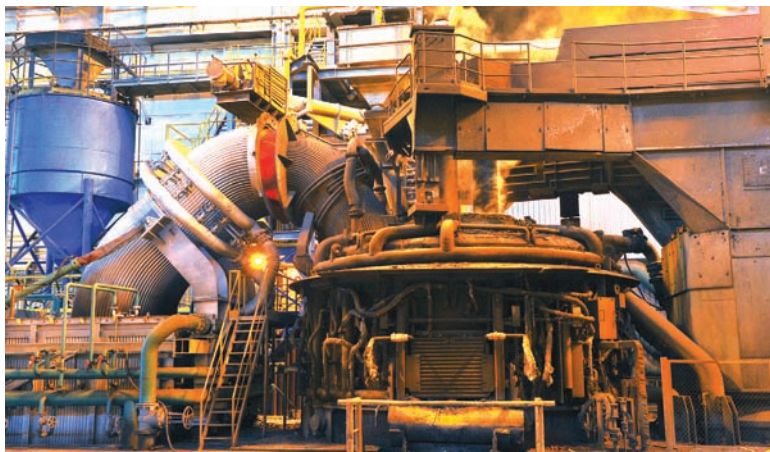
В этой печи — ДСП-120 — был успешно сварен металл для сифонного слитка
