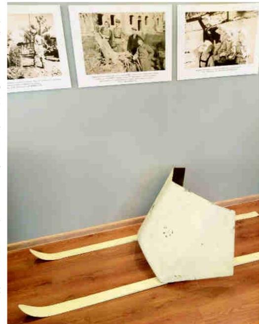
Бронецит «ЗБШ» Ижорского завода. Установлен на лыжи. 1940-41 гг.
