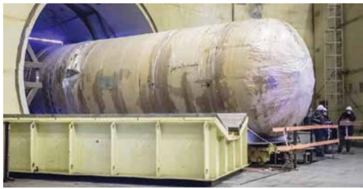
Крышка блока верхнего является съемной частью реактора и воспринимает его внутреннее давление. Она предназначена для уплотнения реактора, размещения приводов системы управления и защиты (СУЗ) реактора, размещения выводов каналов внутриреакторного контроля и удержания от всплытия внутрикорпусных устройств и тепловыделяющих сборок.
