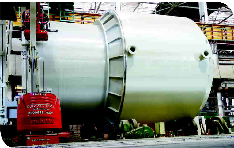
Длина транспортного шлюза – 14 метров, диаметр центральной секции – 9 метров, вес в собранном виде – 280 тонн
