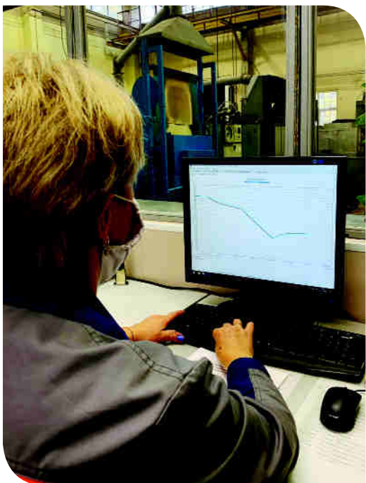
Единая сеть позволяет контролировать и архивировать режимы термообработки всех печей участка
