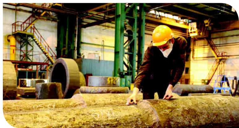
Разметчики обмеряют каждую заготовку послековки, сверяют ее размеры с заданными параметрами и размечают поковку для последующей механической обработки
