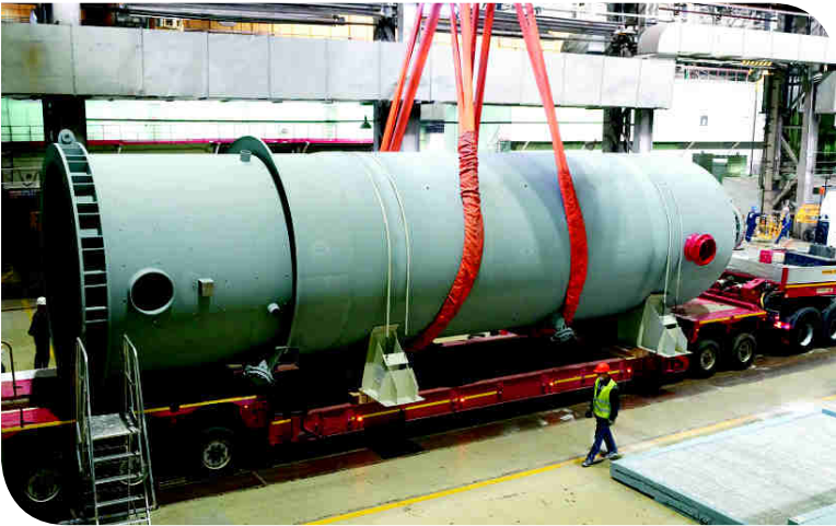
Высота реактора изодепарафинизации – 15,8 метра, внутренний диаметр – 3,5 метра и масса – 98,8 тонн
