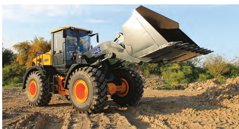
Колесный фронтальный погрузчик с ковшом вместимостью 3,5 м³
