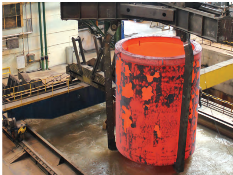
Обечайка ВВЭР-ТОИ на термообработке. Лето 2014 года
