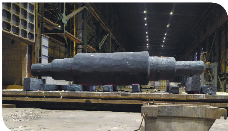
Это второй в истории российского машиностроения цельнокованный валок для станков таких размеров
