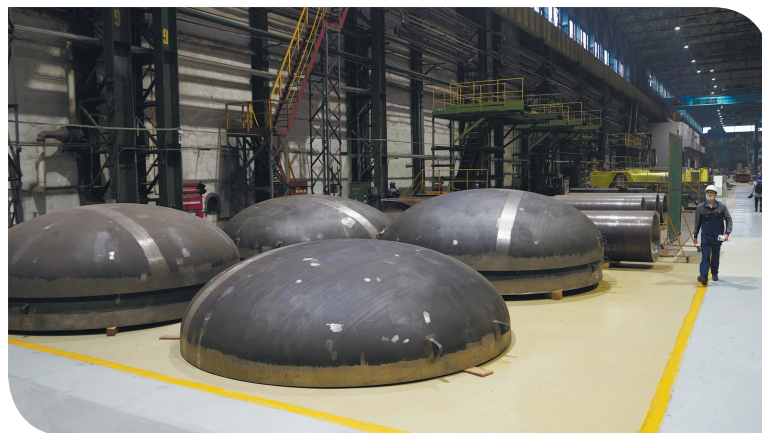
СПЗАЗ – ключевой элемент системы безопасности АЭС. Емкости предназначены для отвода остаточных тепловыделений в случае возникновения аварии теплоносителя первого контура
