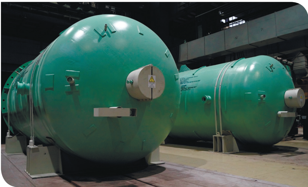
Наружный диаметр каждой емкости СПЗАЗ - 4,2 метра, длина – 11 метров, вес – 80 тонн
