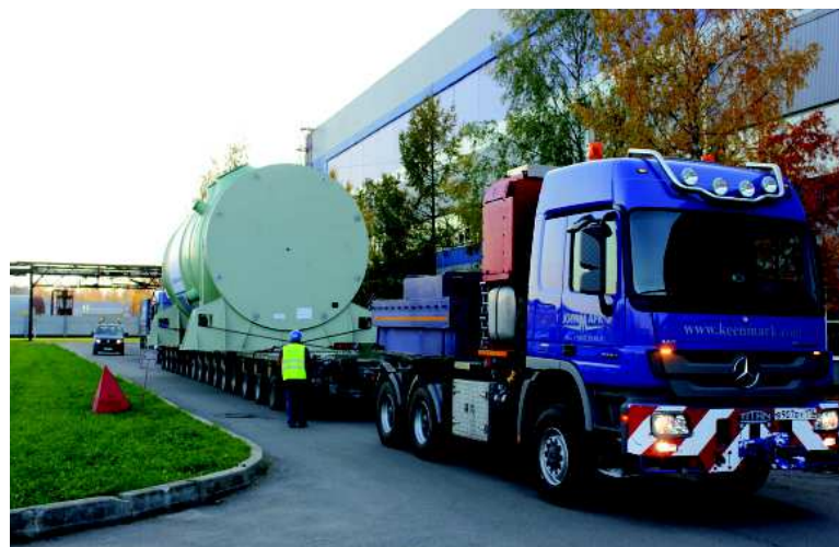
Корпус реактора движется в сторону Октябрьской железной дороги
