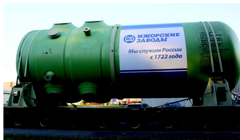
Первый этап отгрузки – корпус реактора выехал из цеха №33
