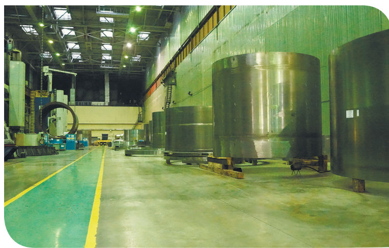
Для производства корпуса парогенератора необходимы четыре обечайки: две центральных и две боковых, а также два днища
