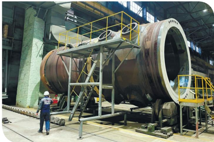
Изготовление корпуса реактора выполняется в рамках договора с компанией АЭМ-технологии
