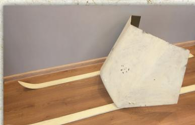
Бронещит «ЗБШ» Ижорского завода. Установлен на лыжи. 1940-41 гг.
