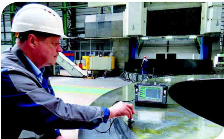
Проведение ультразвукового контроля заготовок
