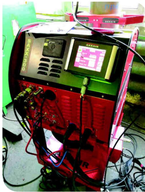
по автоматической сварке неповоротных стыков труб различных типоразмеров, изготавливаемых из заготовок сталей различных марок.
