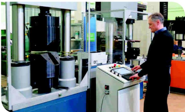
Испытания на статический изгиб и растяжение
