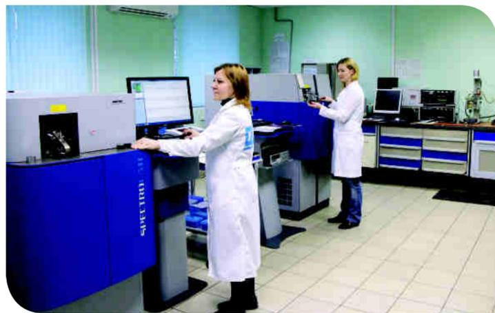
Химический анализ стали по ходу выплавки
