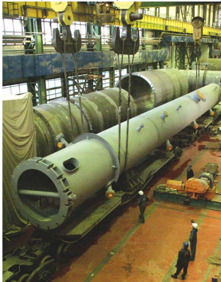
Погрузка реактора на транспортер
