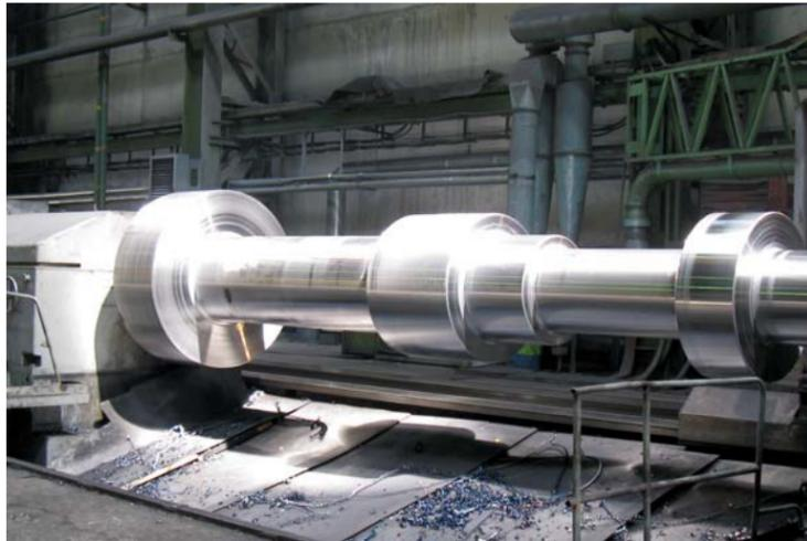
Вал для финской фирмы ABB после чистовой обработки сверкает, как серебряный
