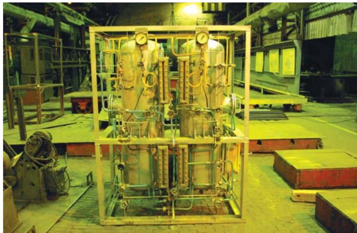
Специалистами Уралхиммаша совместно с инжиниринговой компанией «АСК Технологии» (Москва) разработаны новые, соответствующие современным требованиям к данному оборудованию модульные электролизные станции ЭСМ-10, предназначенные для производства водорода методом электролиза воды.
