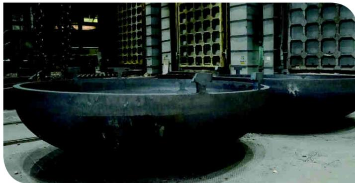
Наружный диаметр каждой гидроемкости СПЗАЗ – 4,2 метра, длина – 11 метров, вес – 80 тонн. В комплект системы входит 16 днищ. Масса каждого из них – 12 тонн
