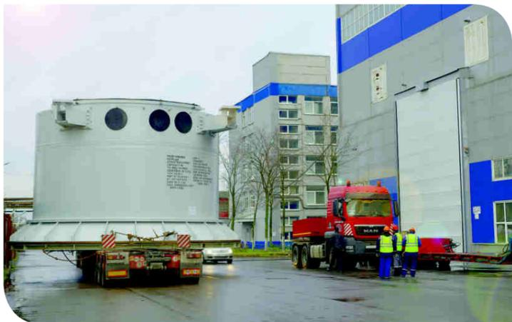
В собранном виде шлюз весит 280 тонн, его длина составляет 14 метров, а диаметр центральной секции – 9 метров
