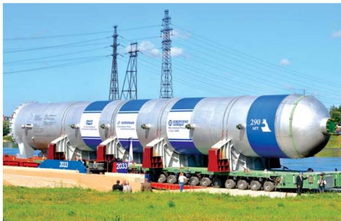
В 2012 году Ижорские заводы изготовили и доставили заказчику – Туапсинскому НПЗ – шесть тяжелых емкостных аппаратов, предназначенных для глубокой переработки нефти
