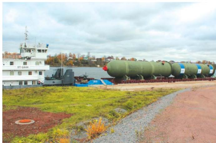
В адрес Куйбышевского НПЗ одной баржей были отправлены сразу два реактора гидроочистки
