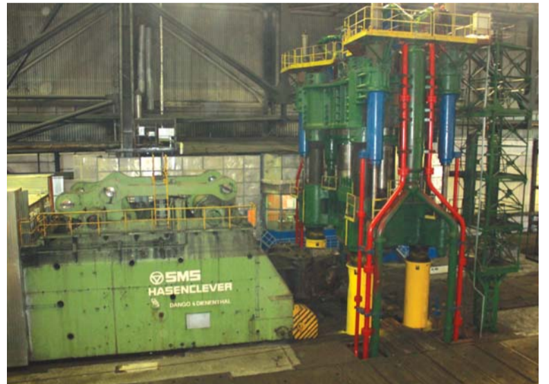
На этом прессе усилием 12 000 тс впервые в России отштампованы заготовки для днищ крупных сосудов НХО
