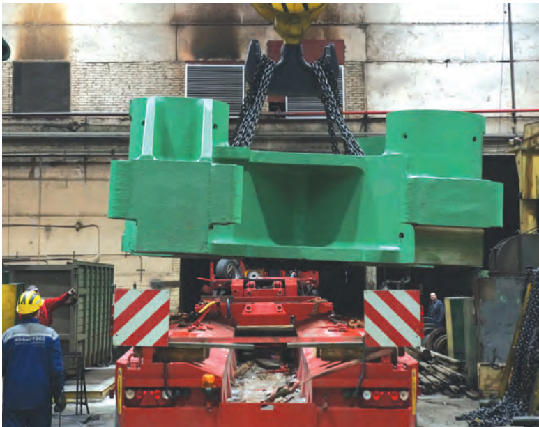
Отгрузка изделия заказчику: погрузка траверсы на транспортер
