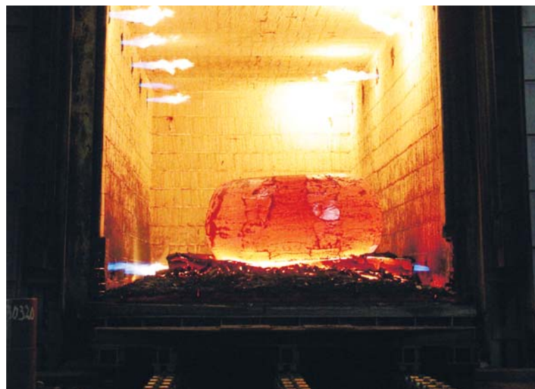
Посадка заготовки фланца в термическую печь
