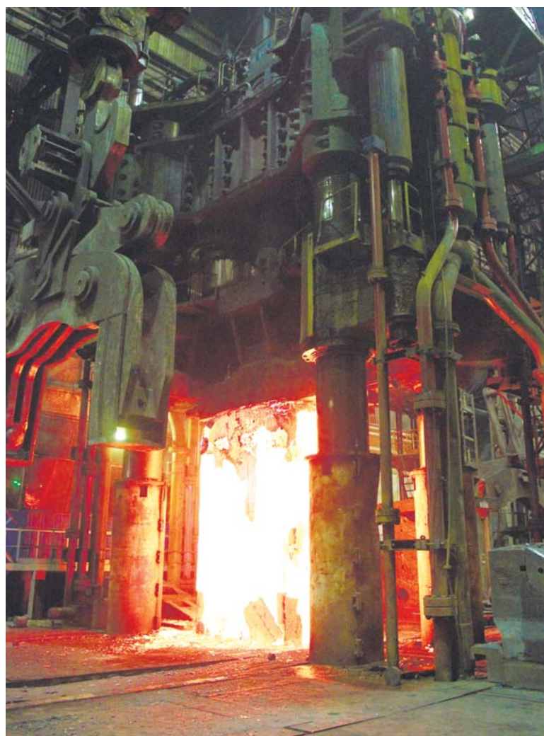
Шабот изготавливается из слитка весом 420 тонн
