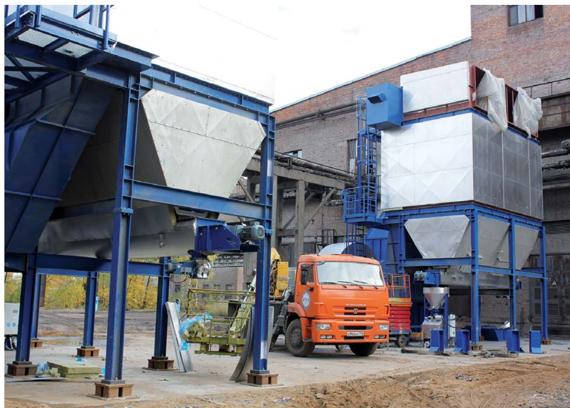
Установка обеспыливания для установки регенерации и установка пылеулавливания для выбивной решетки
