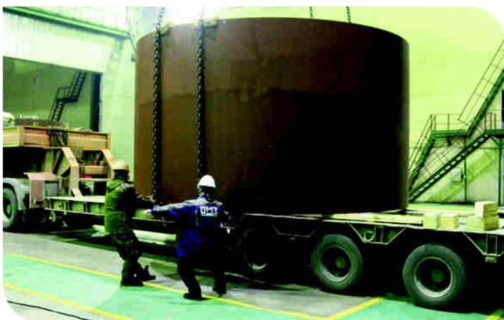
Процесс погрузки обечайки корпуса парогенератора для энергоблока №8 АЭС Тяньвань в механотермическом цехе №66. Масса обечайки центральной – более 43 тонн
