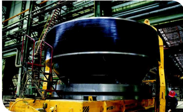
Крышка верхнего блока для энергоблока №1 АЭС Руппур в цехе №33 Ижорских заводов
