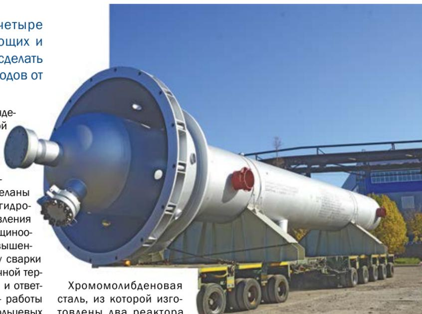
Хромомолибденовая сталь, из которой изготовлены два реактора
