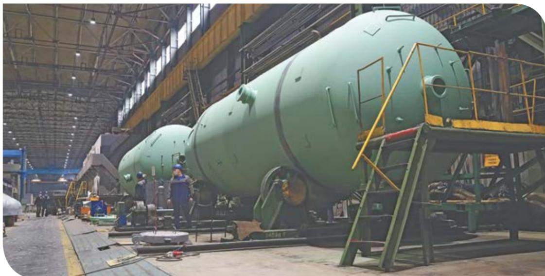
Гидроемкость системы аварийного охлаждения реактора.
