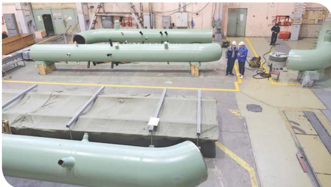
Комплекты трубных узлов главного циркуляционного трубопровода (ГЦТ)
